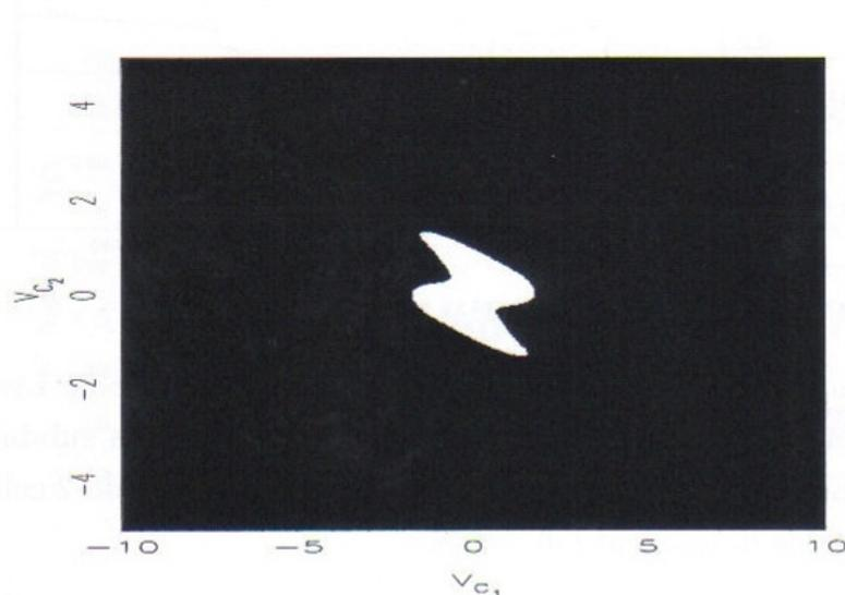
Figura 4.17: Bacia de atração para o Espiral-Dupla próximo à crise de fronteira ( $g = 0,6555$ ). Aumentando-se o parâmetro  $g$ , o Atrator caótico colide com a órbita tipo sela, desaparecendo juntamente com sua bacia. Nota-se a diminuição desta em comparação com a Figura 4.16.
