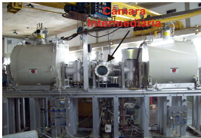
Figura 4: Foto mostrando os dois solenóides supercondutores, instalados na canalização 45B do laboratório Pelletron, e a câmara onde são realizados os experimentos atualmente.
