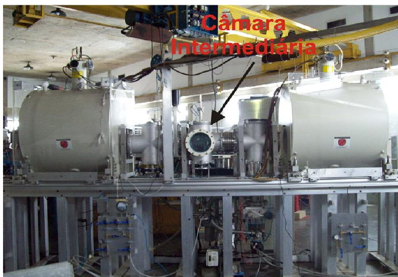
Figura 2: Foto mostrando os dois solenóides supercondutores, instalados na canalização 45B do laboratório Pelletron, e a câmara onde são realizados os experimentos atualmente.
