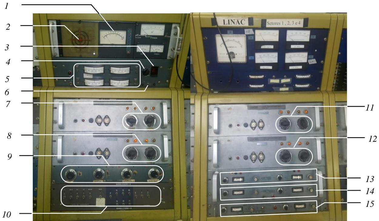
Figura 7 - Painéis da óptica do feixe
