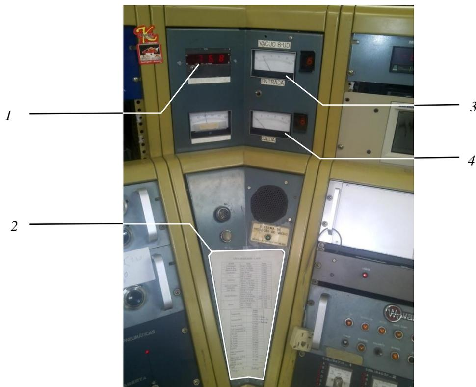
Figura 5 - Painel de Leitura das Pressões do Tanque
