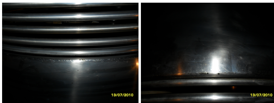
Figura 2: Marcas de faíscas no terminal (A) Borda superior e (b) Borda inferior.
