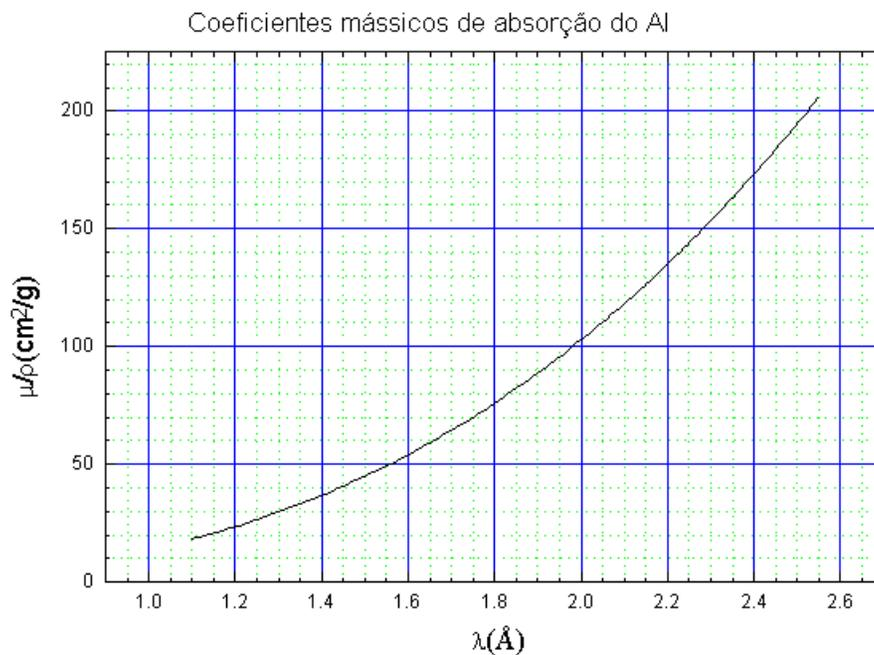
Figura 2. Coeficientes mássicos de absorção do Al em função do comprimento de onda  $\lambda$  da radiação eletromagnética incidente.Tabela 1: Comprimentos de onda das emissões K dos elementos de  $23 \leq Z \leq 30$
