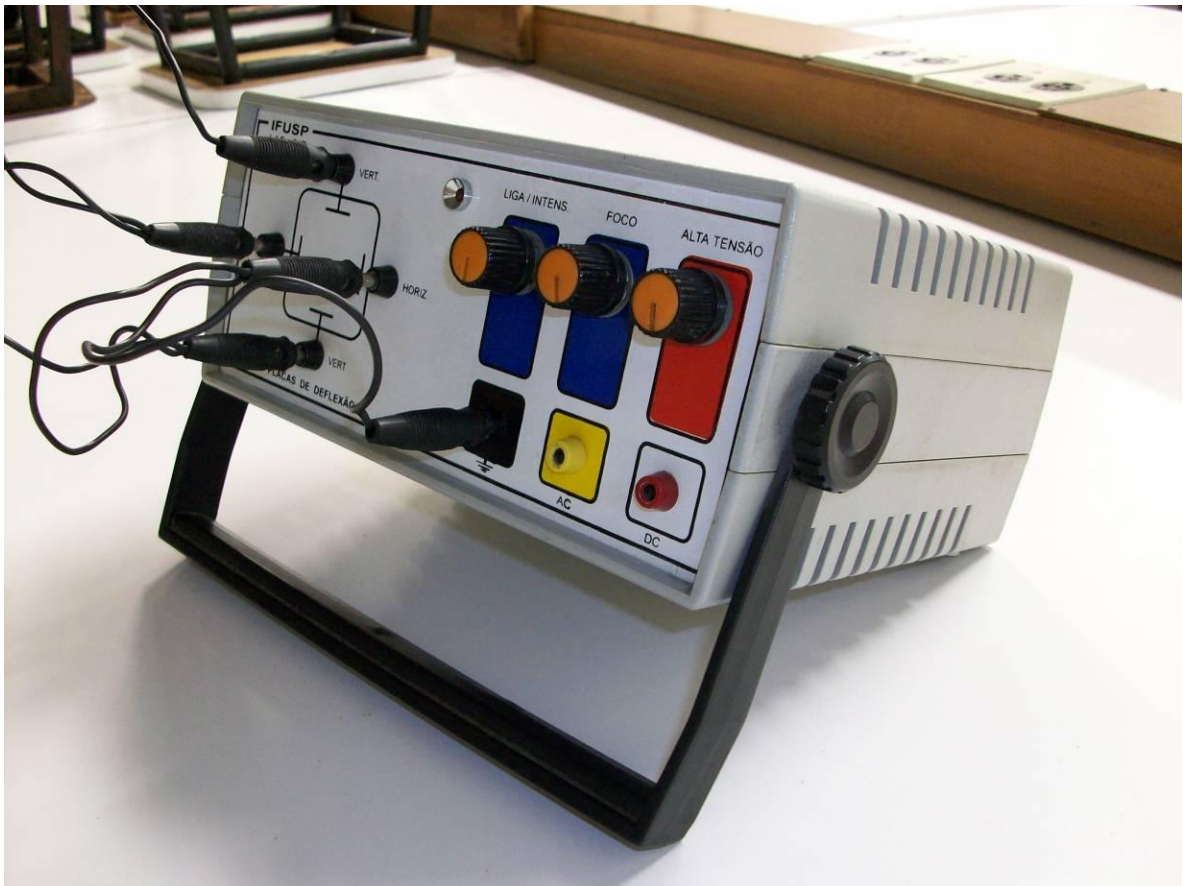
Figura 3: Conectores das placas defletoras ligados ao Terra.
