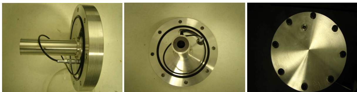
Figura 4 – Flange do sistema de Tempo de Vôo, que abrigará o detector de partículas.
