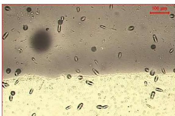
Figura 3.16: Detector com o retículo de vidro visualizado através do microscópio.
