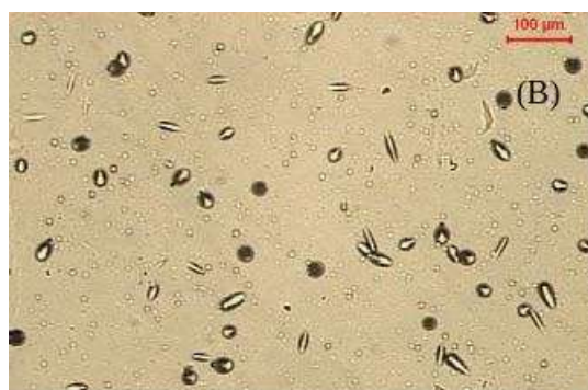
Figura 3.15: Imagem de parte de um detector, onde é possível observar os traços referentes a incidência das partículas alfa.
