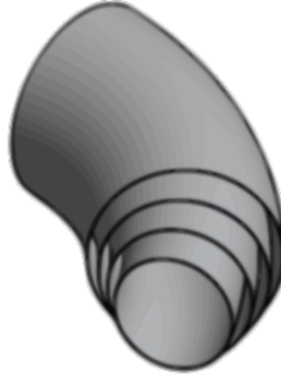
Figura 2.1: Pequeno segmento toroidal ilustrando o arranjo das superfícies magnéticas.
