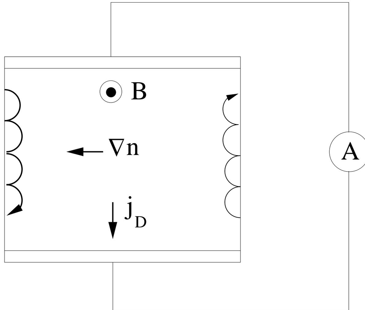
Medindo a corrente diamagnética em um plasma não homogêneo.
