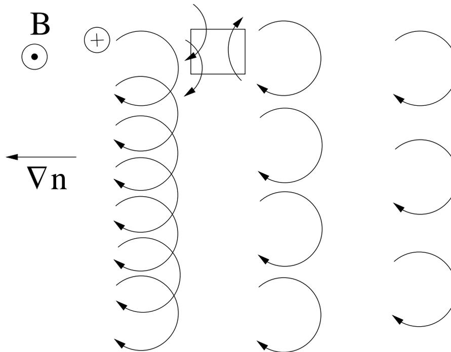
Como ions e elétrons desviam em direções opostas, há uma corrente diamagnética. Para  $\gamma = Z = 1$ , é dada por
