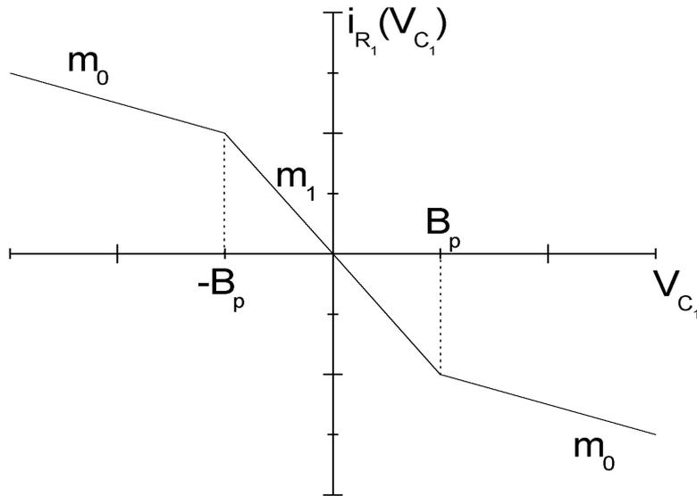
Função da curva característica da resistência linear por partes:
