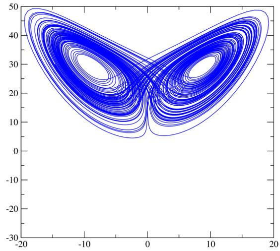
**Figura 5** – Para  $r = 30$ , só existe o atrator caótico
