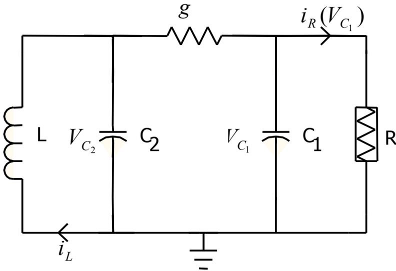
Fig.1. Circuito de Chua.  $R$  é a resistência não linear.
