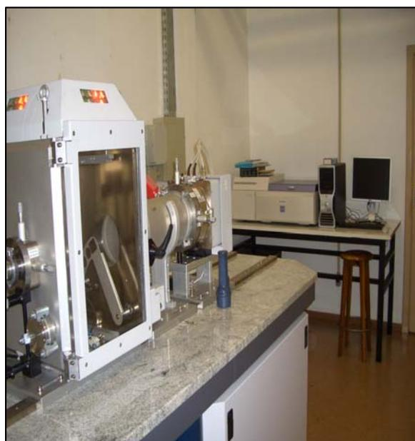
Fig. 1: (a) Vista lateral do aparelho de SAXS e WAXS Nanostar instalado no LCr. DE esquerda a direita observa-se o suporte do tubo de raios X, o alojamento dos espelhos de Gobbel, os posicionadores dos conjuntos de colimadores, a câmara porta-amostra, o caminho de vácuo e o detetor sensível à posição multifilar. (b) Vista parcial do aparelho principal e, a direita, acessório leitor de image plate.
