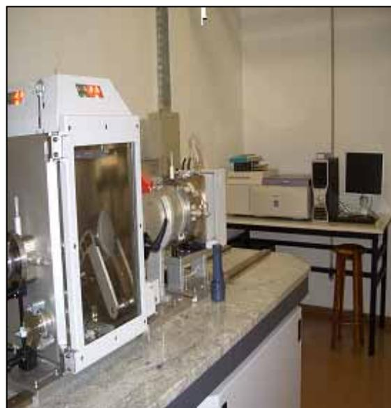
Fig. 1: (a) Vista lateral do aparelho de SAXS e WAXS Nanostar instalado no LCr. Da esquerda para a direita observa-se o suporte do tubo de raios X, o alojamento dos espelhos de Gobbel, os posicionadores dos conjuntos de colimadores, a câmara porta-amostra, o caminho de vácuo e o detetor sensível à posição multifilar. (b) Vista parcial do aparelho principal e, à direita, acessório leitor de placa de imagem.
