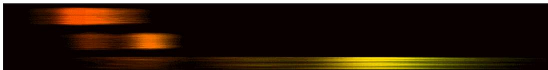
*Na figura, três espectros de um impulso laser colidindo com uma frente de plasma ionizado em rápida translação. No topo, o pulso original, na do meio, a colisão em modo contra-propagada e na imagem inferior o resultado de uma colisão co-propagada. A redução do comprimento de onda (indicado pelo deslocamento das franjas para a direita) evidencia a aceleração de fótons por uma frente relativística de plasma ionizado.*
