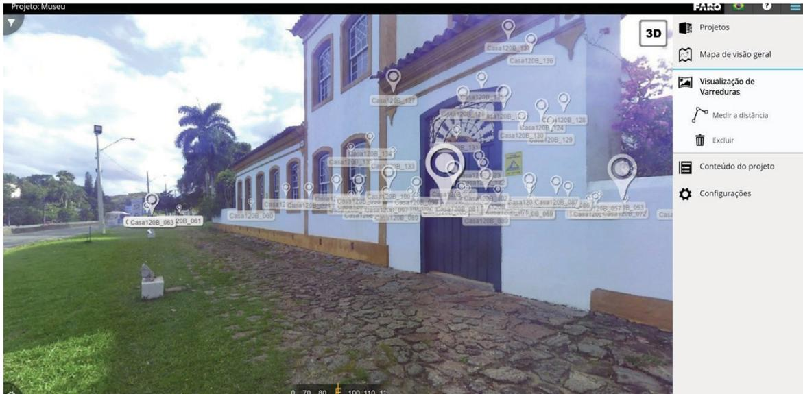
Figura 3: Escaneamento por nuvem de pontos. Fonte: Autores (2019).
