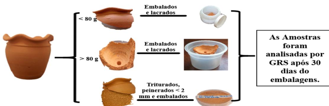
**Figura 1:** Esquema representativo da preparação das amostras dos vasos cerâmicos comerciais para testar os métodos a ser medido por GRS.
