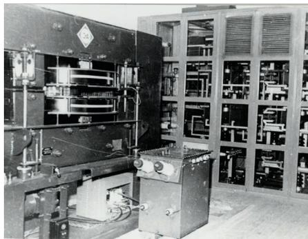
Banco de condensadores e núcleo magnético do Betatron
