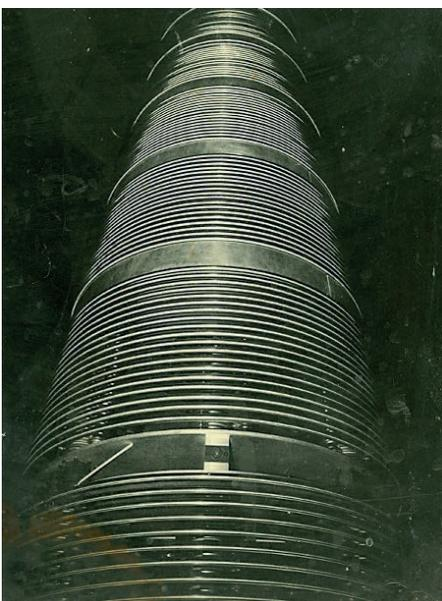
Interior do tanque maior, que envolve o acelerador. Cada parte lisa representa a junção de seções. Pode-se ver quatro das oito seções da coluna abaixo do terminal e as oito seções acima. Os 19 anéis de cada seção são afixados a uma estrutura isolante em planos paralelos. Com o espaçamento entre os anéis e todo o volume do tanque pressurizado a 8 atmosferas de gás isolante de hexafluoreto de enxofre, a diferença de potencial entre um anel e outro pode chegar a 50 kV, sucessivamente, sem descarga.
