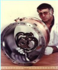
O sistema de cavidades é resfriado à temperatura de Hélio líquido 3K quando o Nióbio se torna supercondutor. As estações dedicadas à criogenia para a produção necessária de Hélio e Nitrogênio líquidos podem ser vistos no slide abaixo.
