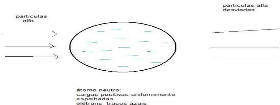
As partículas alfa têm cargas elétricas positivas e incidem sobre o átomo formado por uma massa uniforme de cargas positivas com os elétrons distribuídos ao acaso. Uma carga positiva será repelida por cargas positivas e atraída pelas negativas. Essa situação pode ser calculada exatamente, considerando as forças eletrostáticas atuantes e que resultam em desvios pequenos.
