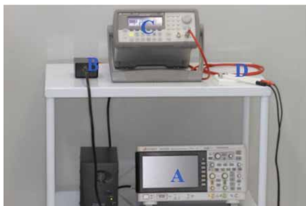
Figura 19. O produtor de sinal elétrico e aparelho. A unidade inclui um osciloscópio (A), uma fonte de alimentação (B), um produtor de sinal elétrico e placa de circuito atual (C) e dois eletrodos condutores do tipo bastão (D)
